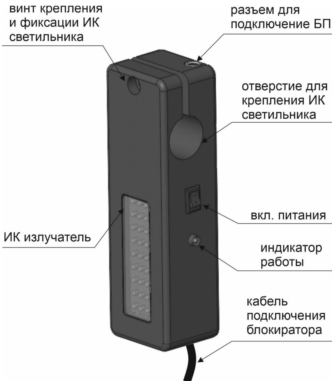
Для правильной и безотказной работы системы дистанционной блокировки - разблокировки спускового крючка огнестрельного оружия, необходимо расположить ИК светильник и блокиратор согласно представленной схеме:
