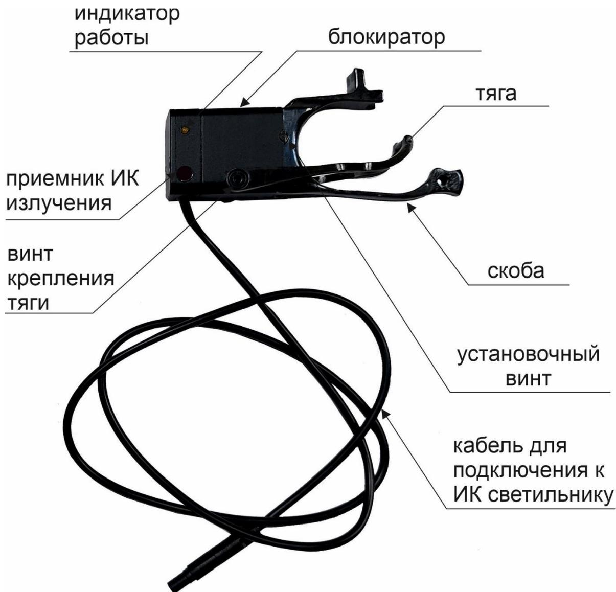
Для моделей пистолетов GLOCK, VIKING\_CZ, используется стандартная система крепления на пистолет, через переходник и фиксируется винтом. Различаются только тяги блокирующие спусковой крючок.
